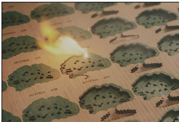
Ryc. 20 i 21. Wypalanie laserem i finalny produkt (Mi 3352).
